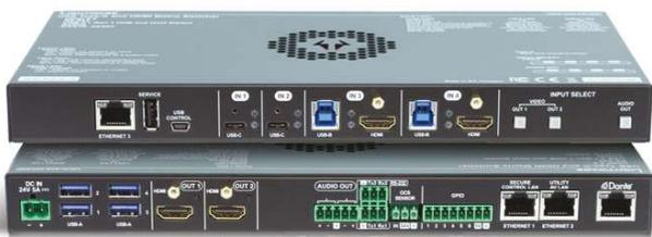
Compatibilité Full HDMI 2.0 permettant des signaux 4K 60Hz 4:4:4
